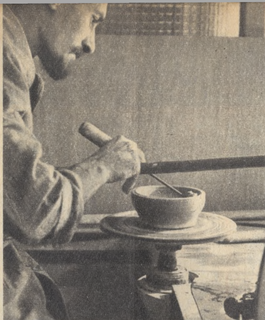
L'écuelle a maintenant sa forme définitive. Le potier se livre au polissage.
